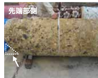
写真1 寸法測定状況(No.1 杭)
