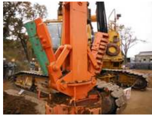
写真4 スクレーパー取付け
