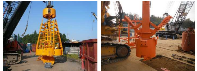
写真1 中間拡径部上部掘削機 写真2 中間拡径部下掘削機
