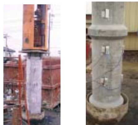
写真2 周面自由杭の実験
