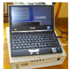
衝撃載荷試験計測システム
