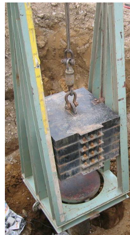
打撃装置 (モンケン重量 2ton)
