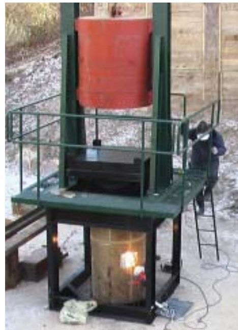
写真1 HCを用いた衝撃載荷試験
