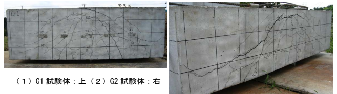
写真-1 最終ひび割れ状況
