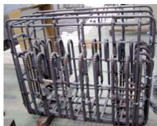
写真-1 配筋図 (試験体 No. 1)
