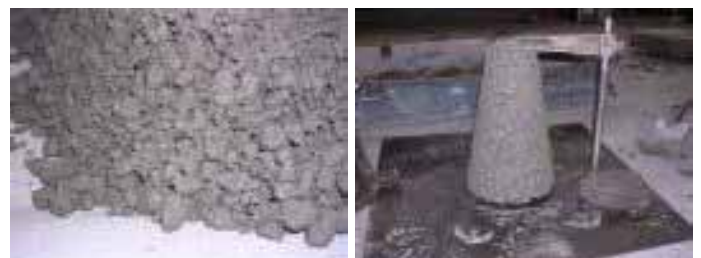
写真 1 練り上がり状態 写真 2 スランプ試験状況
