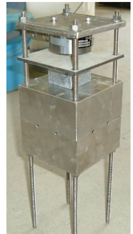
写真 4-1 膨張圧装置外観
