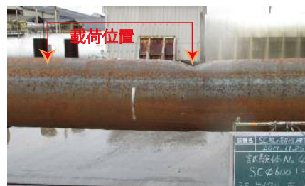
写真1. 中空のケースの破壊状況
