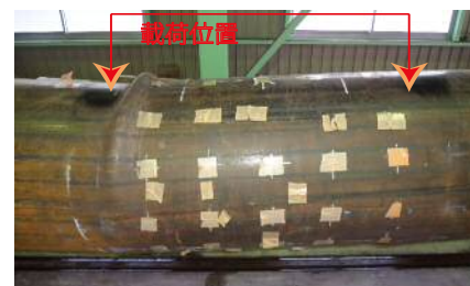
写真2. ケース No. 6 破壊状況
