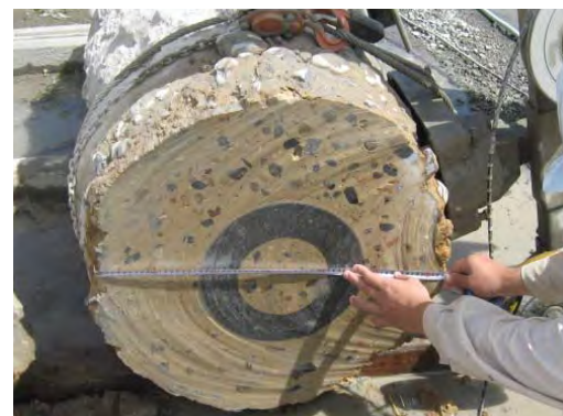
写真 4 杭軸直角方向の切断面 (No.2)
