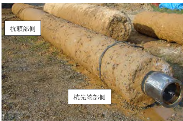
写真8 掘出した杭周囲部 (No.2)
