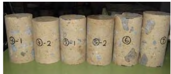
写真6 コア供試体 (No.2: 杭軸直角方向)
