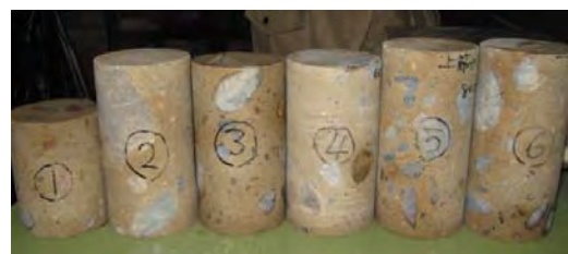
写真7 コア供試体 (No.2: 杭軸方向)
