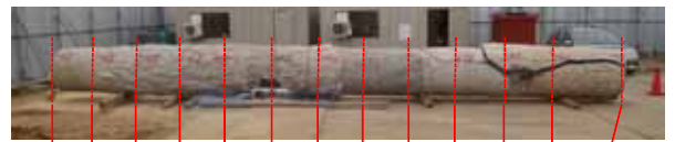
写真1 かぶり厚さ測定及びフェノールフタレイン検査状況
