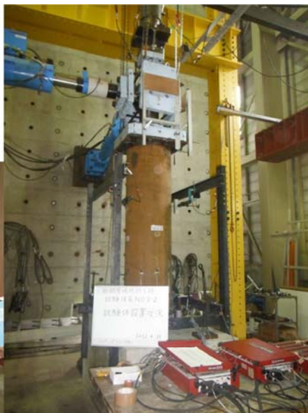
杭頭部曲げせん断試験
