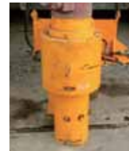
■油圧スィベル 油圧経路をオーガ内部に取り込む装置です。
