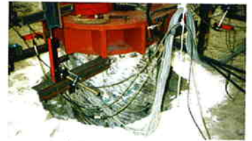
押し込み載荷試験
