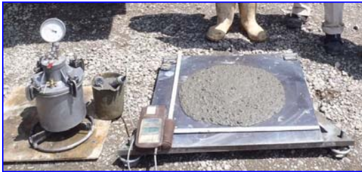
コンクリート強度60N/mm 2 、スランプフロー60cm
