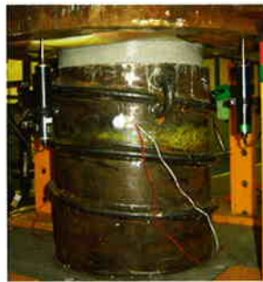
管内リングと球根の付着試験
