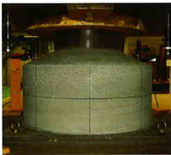
管外突起と球根の付着試験
