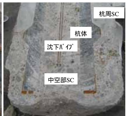
写真-5 先端部分の断面
