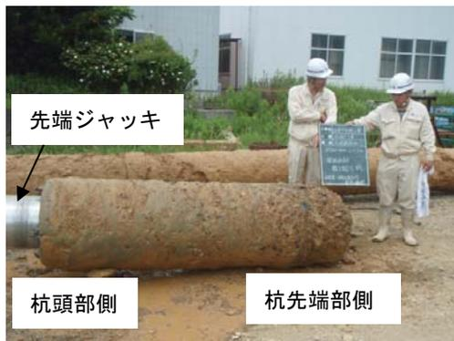
写真3 掘出し後の根固め部 (No.1)
