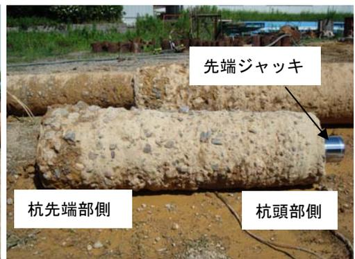
写真4 掘出し後の根固め部 (No.2)
