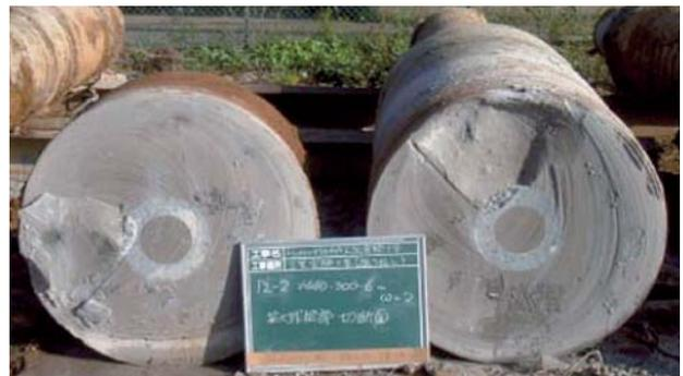
写真-1 掘り起こした杭の根固め部断面
