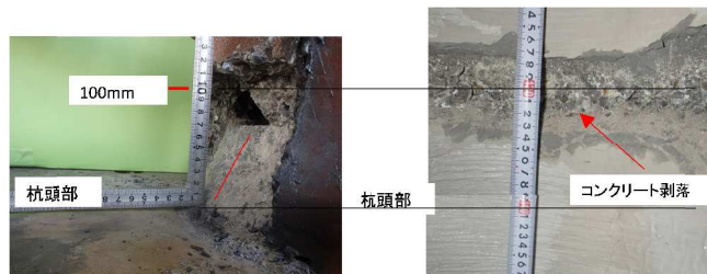
(c) 外殻鋼管除去後 (No. 5) (d) 杭内側 (No. 5)
