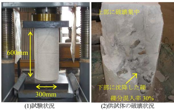
(1)試験状況 (2)供試体の破壊状況
