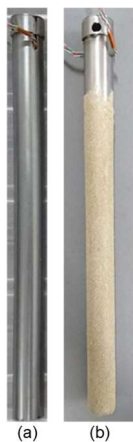
図1 直杭模型、 (a)砂塗布なし、 (b)砂塗布あり
