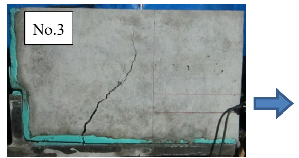
写真2 No.3最終破壊
