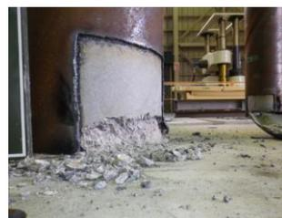
写真 1 No. 1 破壊状況
