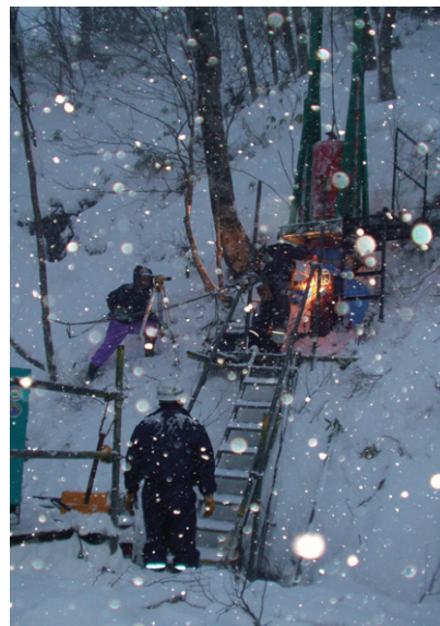
急斜面での試験例 (モンケン質量2t)
